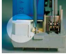
B: Kontak devresi 5, 6 bobin - kontak arası ek fiziksel seperatör (SELV uygulamaları için)
